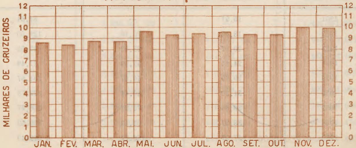
DESPESAS DA TRACÇÃO ELÉTRICA, DIESEL ELÉTRICA E A VAPOR, EM SERVIÇO DE TRENS E MANOBRAS, REFERIDAS A 1000 TONELADAS-KILÔMETRO DE PÊSO BRUTO REBOCADAS.
